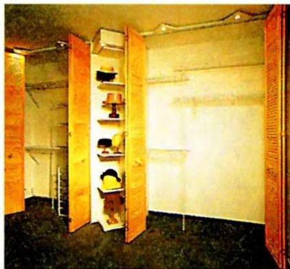
Теперь можно отчётливо представить полезный объём шкафа. За деревянными дверками, покрытыми бесцветным лаком, находятся два отделения шириной по 160 см каждое. Прём между секциями шкафа шириной 70 см занимает открытый стеллаж, который поворачивается в сторону, открывая доступ в нишу, предназначенную для хранения крупногабаритных предметов.
