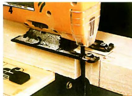
лобзиком. Опиленные детали приклеивают, прижимают струбцинами и крепят шурупами к кромке смежной детали так, чтобы получился законченный кронштейн.
